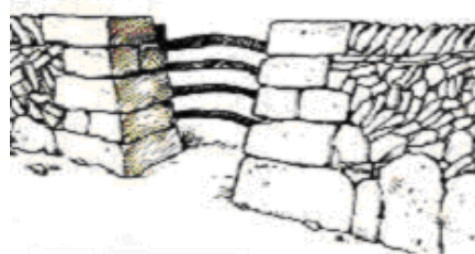
Paret seca i cantonades amb barreres
